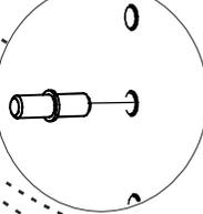
Вариант установки полки на стяжку Rafix
