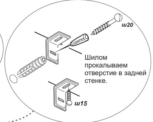
Шилом прокальваем отверстие в задней стенке.
